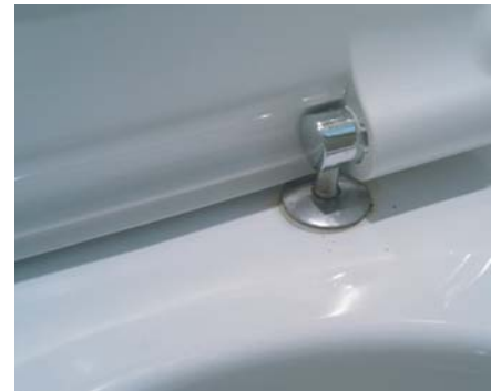
ผิวชุบมีปัญหา จากการใช้น้ำยาเข้มข้นฤทธิ์รุนแรง
